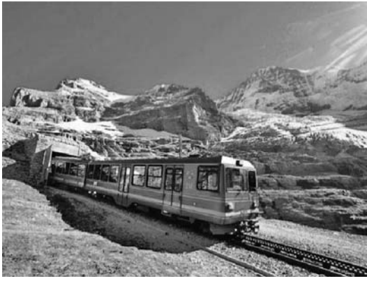
ユングフラウ鉄道（ラックピニオン軌条敷設）
