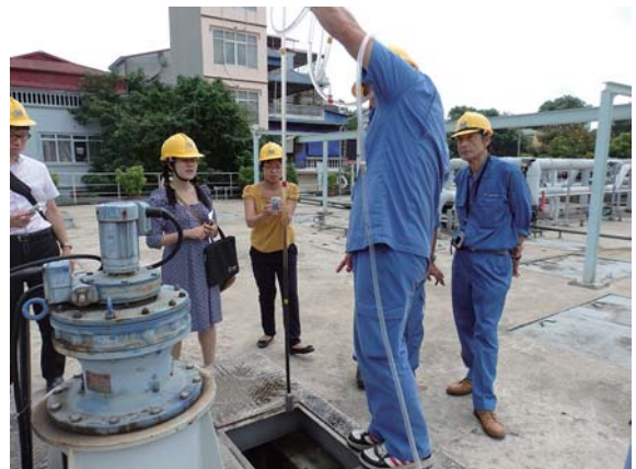
Photo. 5 ゾーンメータを用いた最終沈殿池の界面測定、使用方法の説明
