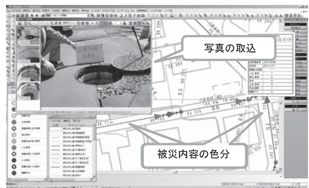
Fig. 5 管路調査における台帳の利用
