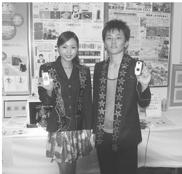
Fig. 4 ウェアラブル太陽電池の試作品(星型太陽電池を 28 個取り付けて、携帯電話を充電)
