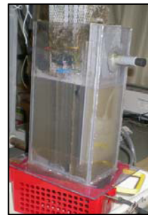
Photo. 1: 電解処理装置
