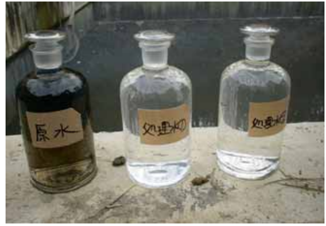
Fig.4 L : Landfill Leachate, C : Run 1, R : Run 2
