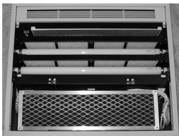
Fig.3 新幹線車両用光触媒脱臭装置(内部)
