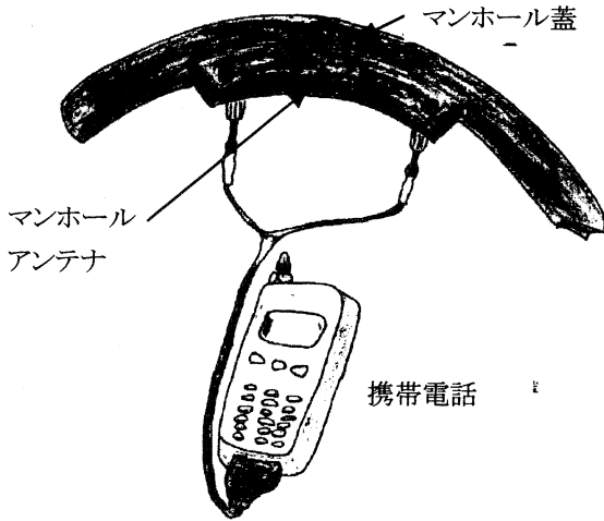
図1 マンホールアンテナと携帯電話
