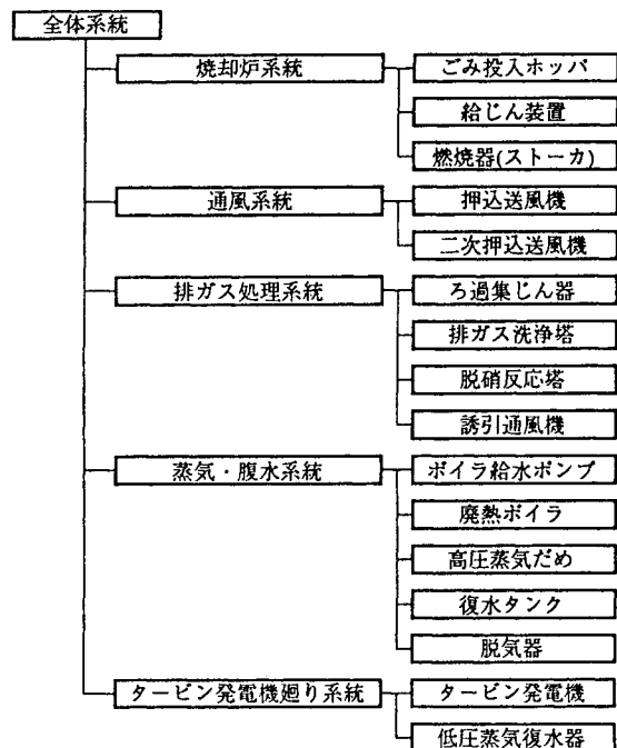
図2：電子マニュアル機能で説明するプラント設備
